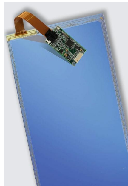
Écran capacitif tactile avec électrodes en ceinture sur les bords avec son système électronique d'exploitation
